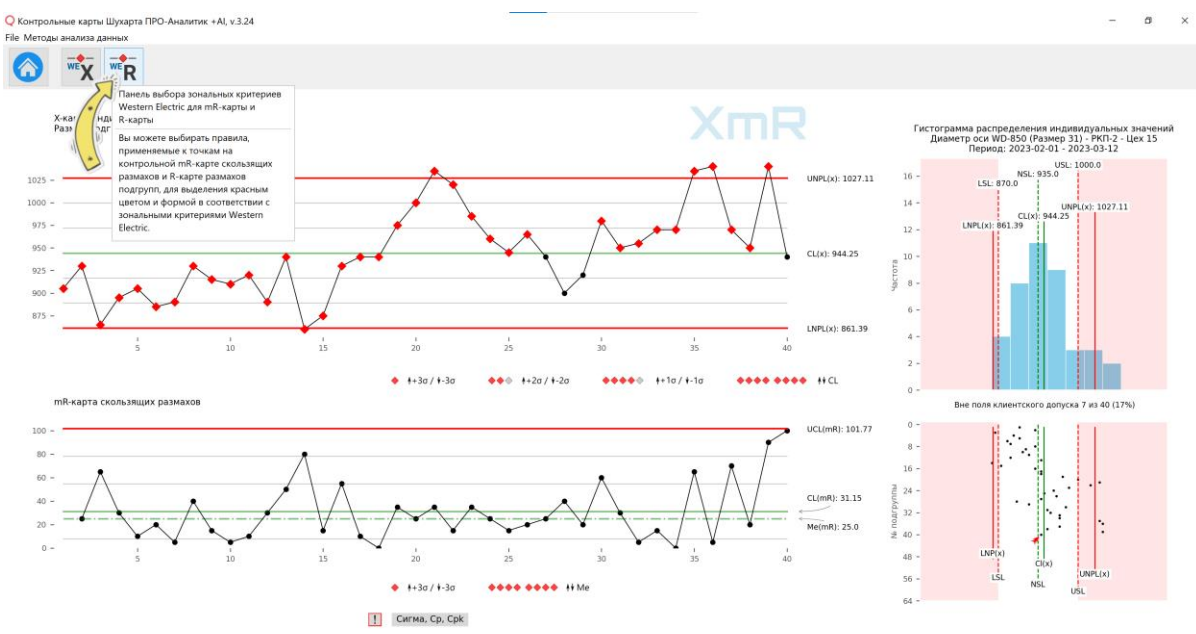
Рисунок 3. Кнопочная панель управления с кнопками управления Правилами для контрольных карт Шухарта. Всплывающая подсказка при наведении мыши на кнопку зональных критериев Wester Electric для mR-карты скользящих размахов или R-карты размахов подгрупп.
