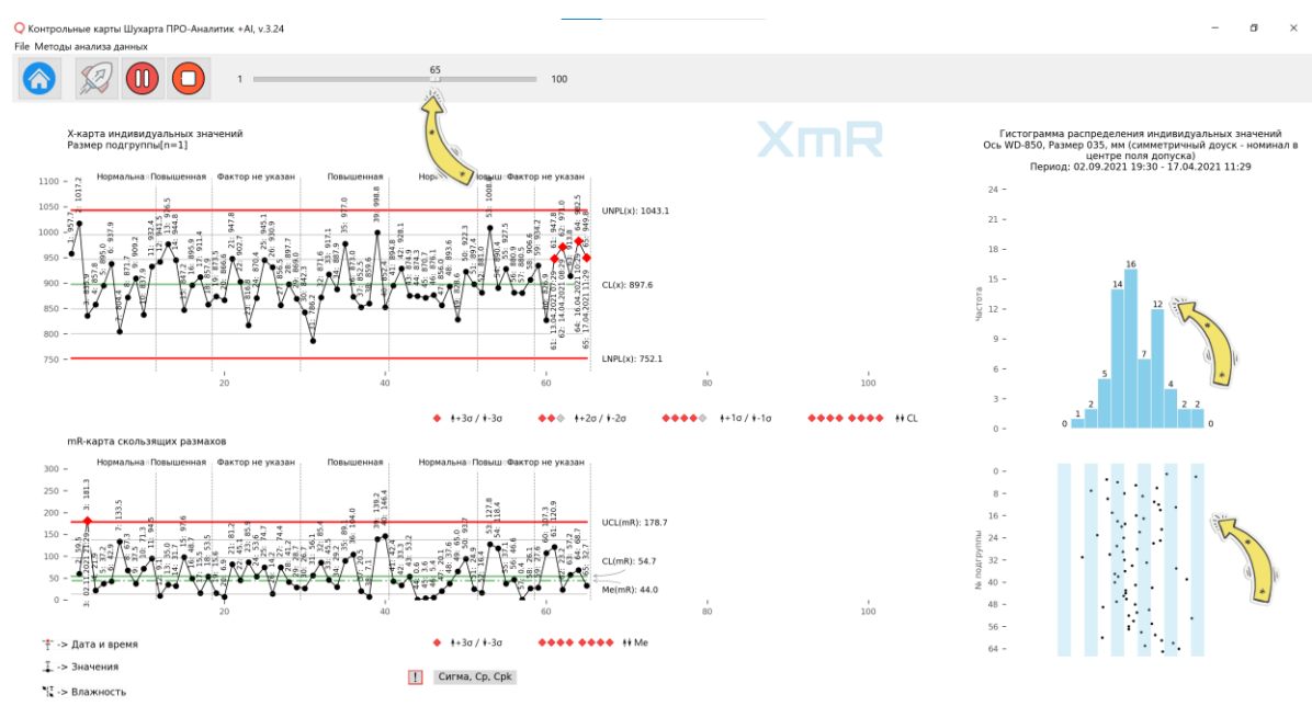
Рисунок 23. Осуществляется (скриншот 65 подгрупп) динамическая демонстрация формирования гистограммы с использованием функции симулятора. График гистограммы остаётся в режиме демонстрации.
