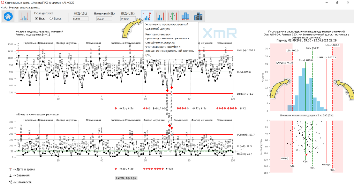
Рис. 11. Выведена всплывающая подсказка при наведении мыши на кнопку [Установить производственный суженный допуск] перехода к панели управления производственным суженным и смещённым допуском. На гистограмме распределения и точечном графике отображён клиентский допуск (LSL, NSL, USL), до применения суженного и смещённого поля производственного допуска.
