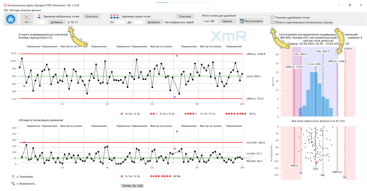
Рисунок 9. Удалённые точки показаны в виде знака [x]. Галочка в чек-боксе вывода области оригинальных контрольных границ установлена. Контрольные границы и центральная линия рассчитаны с учётом только оставшихся точек. Контрольная карта демонстрирует процесс в потенциальном статистически управляемом состоянии. Синяя область на гистограмме демонстрирует область оригинальных контрольных границ, рассчитанных до удаления точек.
