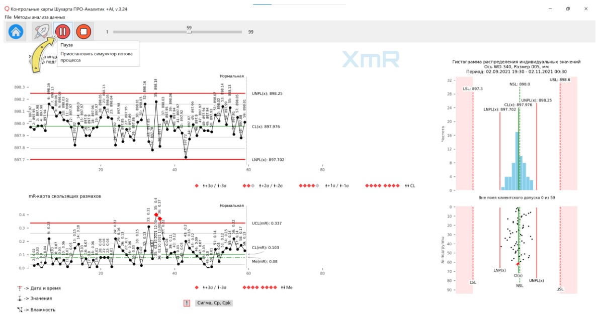
Рисунок 3. Панель управления симулятором. После запуска симулятора кнопка [Старт!] деактивируется, а кнопки [Пауза] и [Стоп!] активируются.
