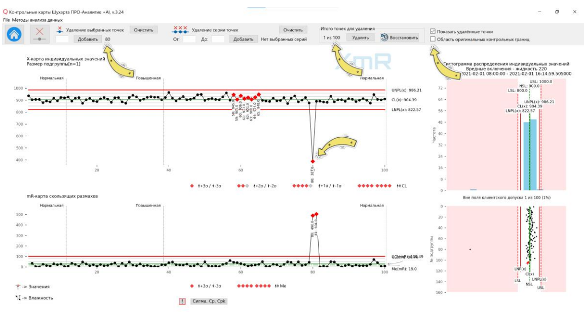
Рисунок 2. Панель управления удалением точек. Установлена галочка в чек-боксе отображения удалённых точек, снята галочка в чек-боксе демонстрации области оригинальных контрольных границ. Точка 80, вышедшая далеко за нижнюю контрольную границу контрольной X-карты индивидуальных значений выбрана для удаления.
