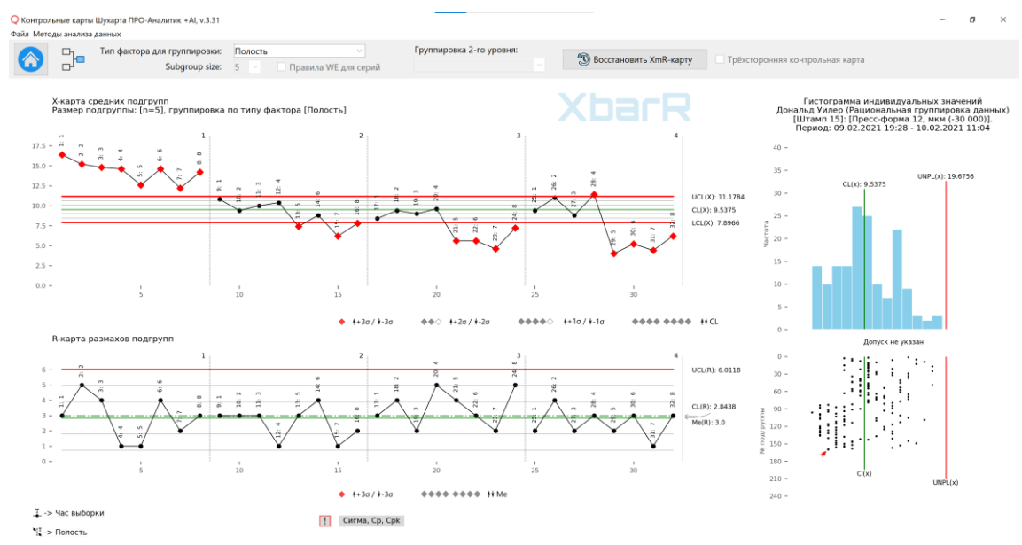
Рисунок 3. Контрольная XbarR-карта средних и групповых размахов для данных, организованных в рациональные подгруппы размером [n=5] для третьего способа организации данных в подгруппах по типу факторов [Полость]. Подписи точек [Час выборки].
