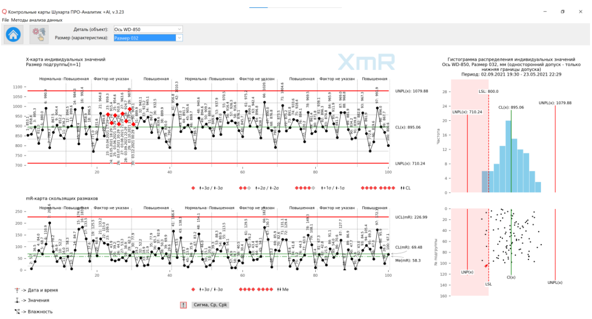
Рисунок 11. Панель управления выбором Детали (объекта) и Размера (характеристики). После изменения значений в полях Детали (объекта) и/или Размера (характеристики), контрольная XmR-карта автоматически перестраивается по этим данным.
