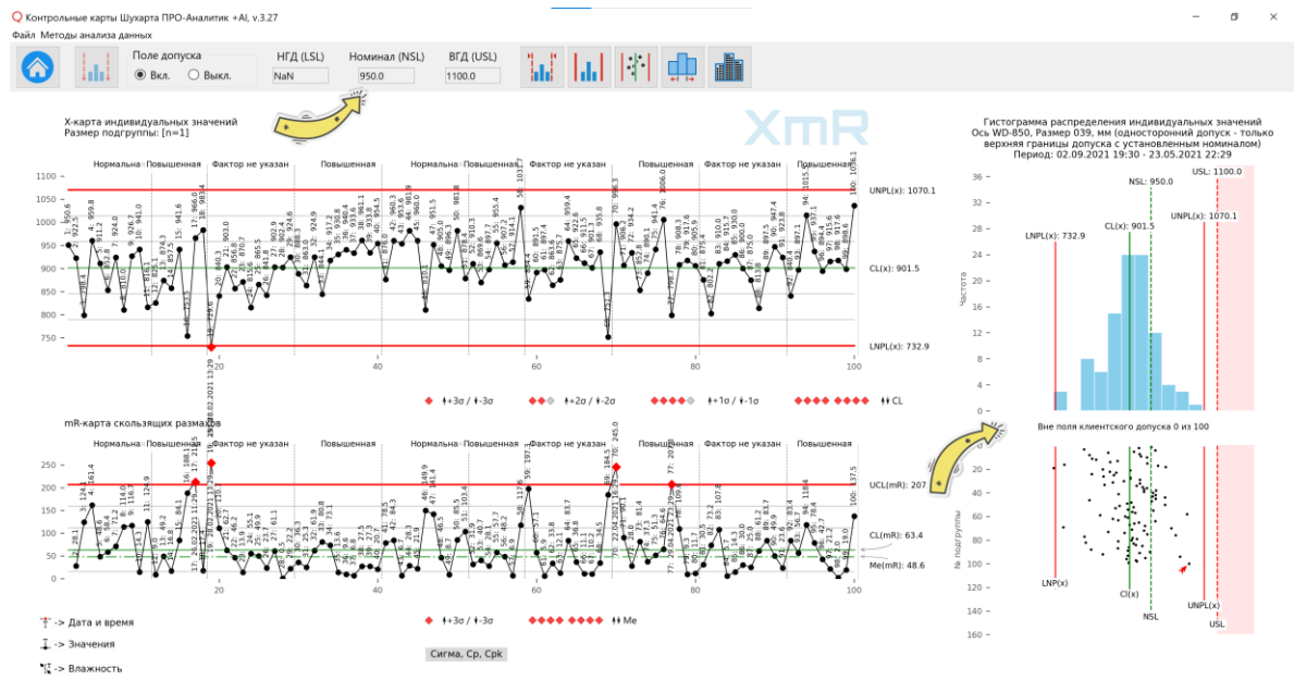
Рисунок 10. Установлена цель процесса - целевое среднее (номинал) и верхняя граница допуска (редкий случай).
