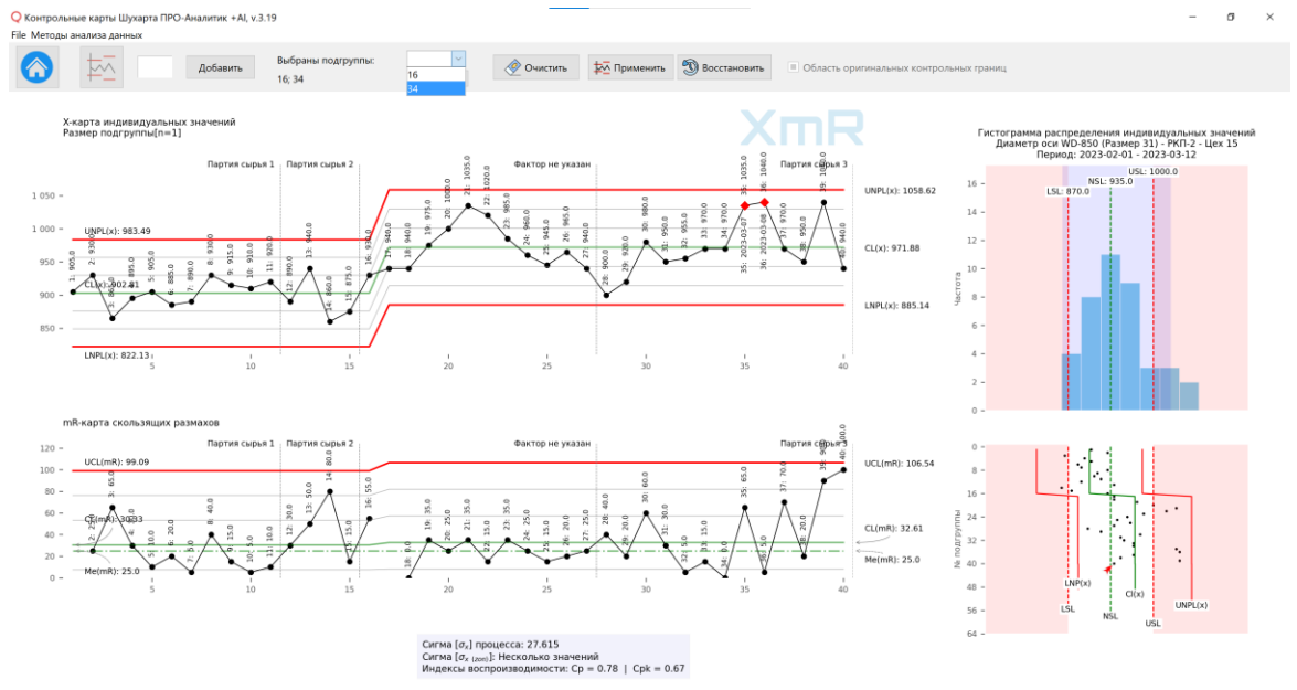
Рисунок 3. Контрольные границы для отдельных серий подгрупп (точек) контрольной XmR-карты Шухарта. Открыт выпадающий список для удаления выбранной подгруппы из списка номеров подгрупп для разделения серий. Анализ контрольной карты осложняется отсутствием в данных указания [Партии сырья] для серии подгрупп от 16 до 27 - сигнал для начала работы с сотрудниками, ведущими записи.
