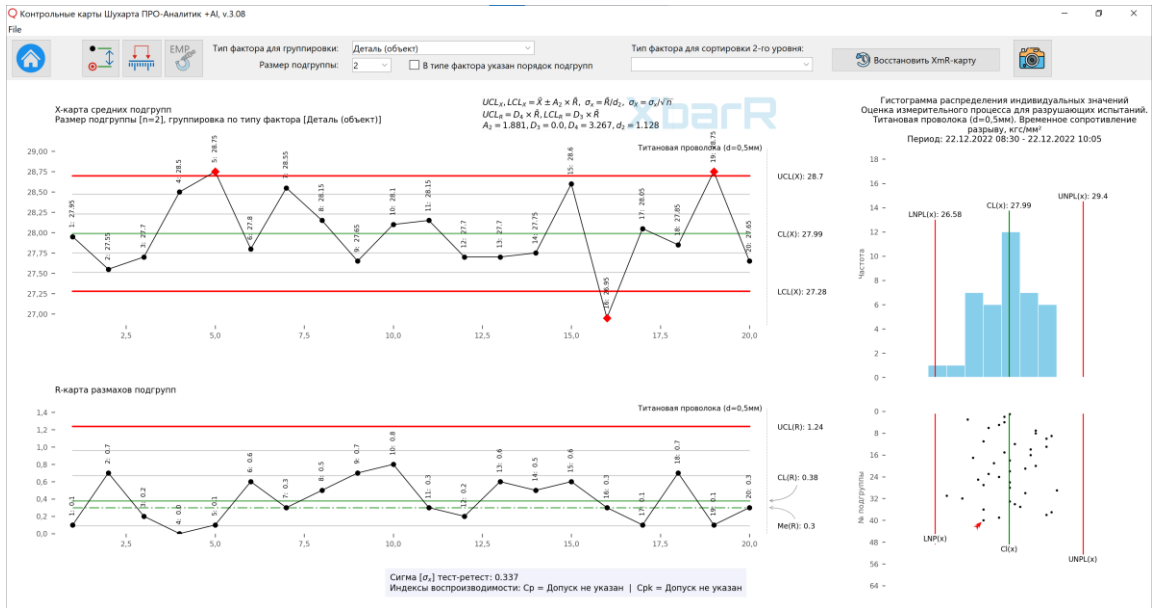
Рисунок 2. Сорок значений повторных измерений (тест-ретест) парных образцов для локализации ошибки измерений (тест-ретест) сгруппированы в подгруппы (n=2). Измерительная система подтвердила стабильность ошибки на R-карте размахов подгрупп с одновременной демонстрацией непригодности этой измерительной системы для отслеживания вариаций процесса из которого взяты образцы для разрушающих испытаний (только 3 точки из 20 оказались выше контрольных пределов на Xbar-карте).
