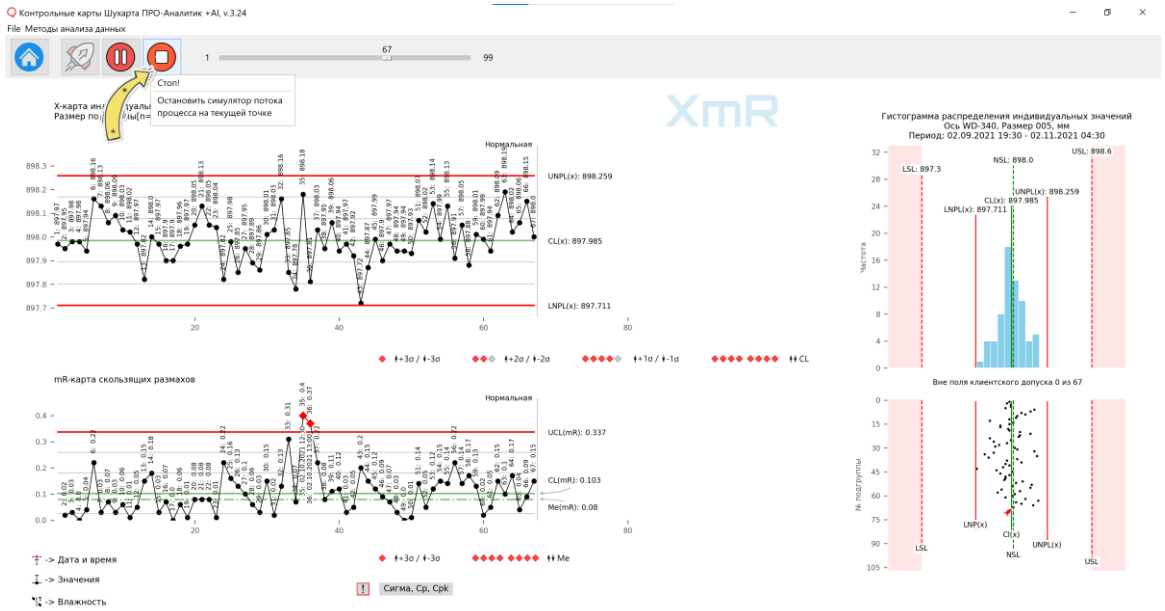
Рисунок 5. Панель управления симулятором. После нажатия на кнопку [Стоп!] симулятор переходит в режим готовности нового запуска, а кнопки [Пауза] и [Стоп!] деактивируется, переходя в начально состояние (рисунок 2). Выведена подсказка при наведении курсора мыши на кнопку [Стоп!].
