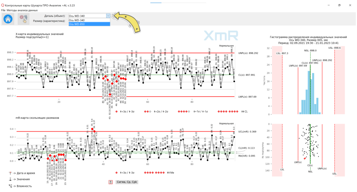
Рисунок 9. Панель управления выбором Детали (объекта) и Размера (характеристики). Открыт выпадающий список Деталей (объектов) в импортированном файле данных.
