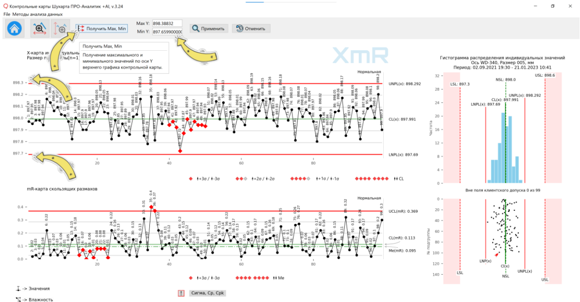
Рисунок 5. Панель управления масштабированием контрольных карт по оси [Y]. Выведена выпадающая подсказка при наведении курсора мыши на кнопку автоматического получения максимального и минимального значения по оси Y (оси значений) текущего графика контрольной X-карты индивидуальных значений, которые вводятся в соответствующие поля значений.
