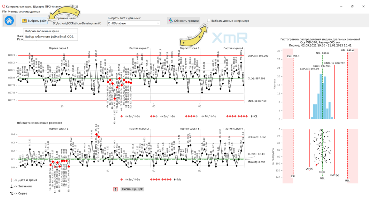
Рисунок 2. Панель выбора файла для построения контрольной карты Шухарта, гистограммы и точечного графика. Выведена всплывающая подсказка при наведении курсора мыши на кнопку [Выбрать файл]. В чек-боксе [Выбрать данные из примера] не установлена галочка.
