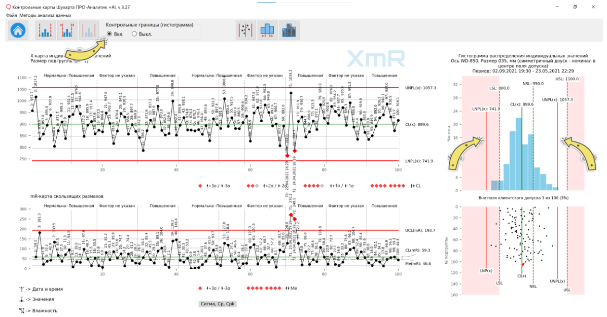
Рисунок 14. Открыта панель управления включением/отключением контрольных границ процесса на гистограмме. Контрольные границы процесса включены.
