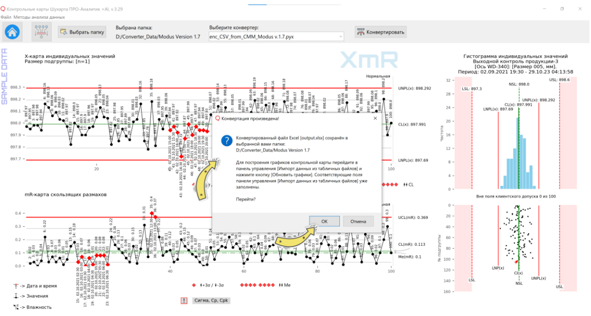
Рисунок 5. Окно панели управления конвертированием файлов. После успешной конвертации всех файлов CSV в выбранной папке выводится информационное окно. При положительном ответе, автоматически открывается окно [Импорт данных из табличных файлов].
