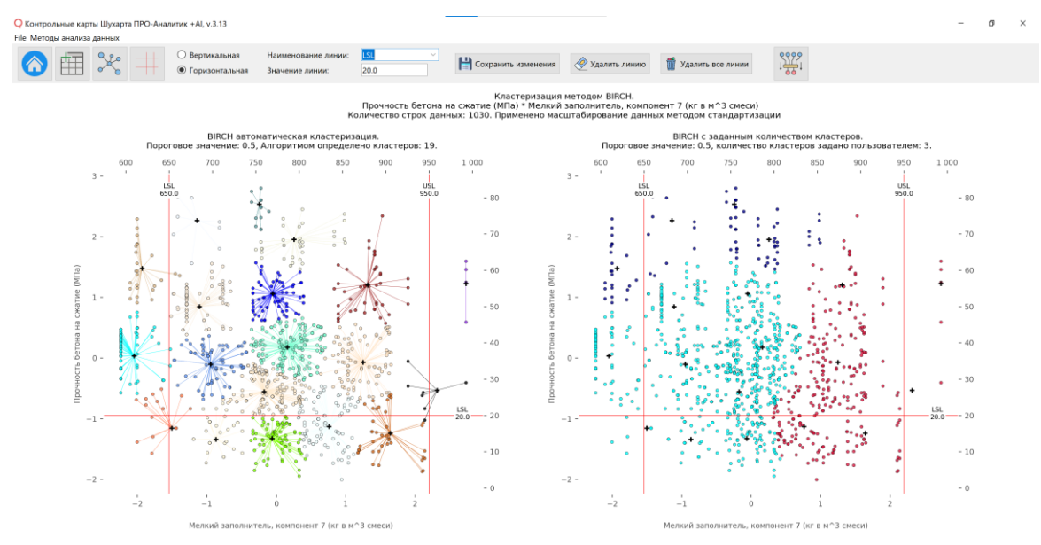
Рисунок 9. Окно функций машинного обучения (Machine learning, ML) - Кластеризация алгоритмом BIRCH. Окно вспомогательной функции нанесения вертикальных и горизонтальных линий на графики. Введены две вертикальные линии с именами и одна горизонтальная. Вы можете выводить любое количество линий с подписями (имя-значение). Можно изменять значение любой выбранной в списке линии. Можно удалять любую выбранную в выпадающем списке линию или все линии сразу.
