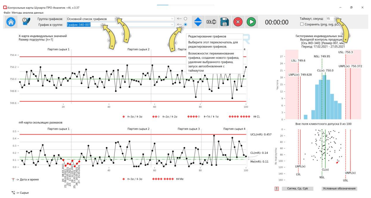
Рисунок 2. Панель управления автоматическим обновлением графиков контрольной карты Шухарта. Введено значение таймаута (15 секунд), выбрана группа графиков и график в списке автообновления. Выведена контекстная подсказка при наведении курсора мыши на активированную кнопку-переключатель редактирования графиков.
