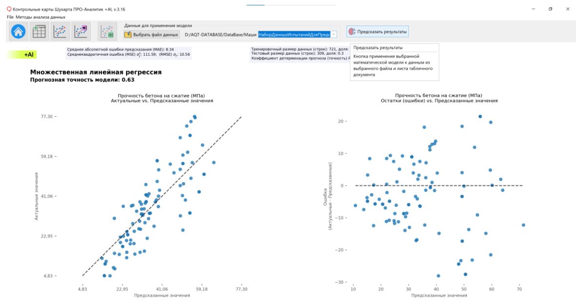
Рисунок 15. Окно функции множественной линейной регрессии. Панель управления выбором данных с независимыми переменными и применения математической модели для предсказания зависимой переменной. Выведена выпадающая подсказка при наведении курсора мыши на кнопку [Предсказать результаты].
