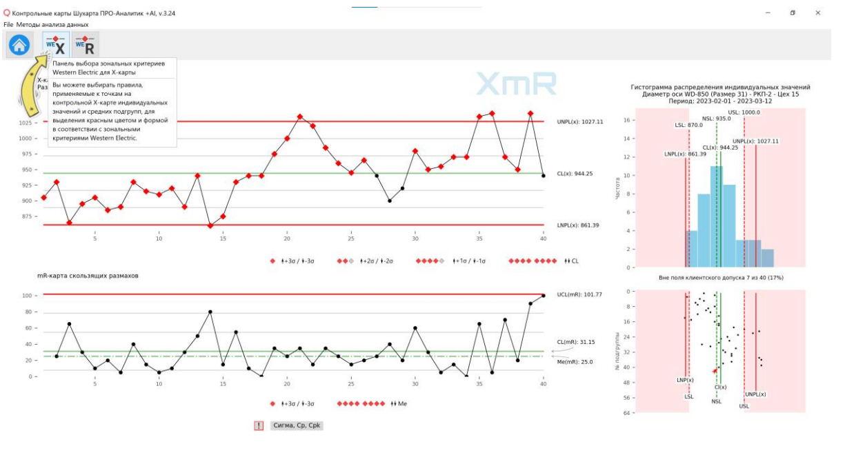
Рисунок 2. Кнопочная панель управления с кнопками управления правилами для контрольных карт Шухарта. Всплывающая подсказка при наведении мыши на кнопку зональных критериев Wester Electric для X-карты.
