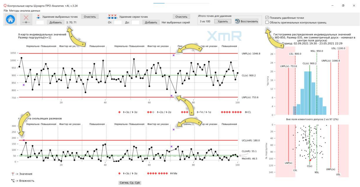
Рисунок 8. Последовательно из контрольной карты Шухарта удалены "красные" точки, которые сохраняются в поле со списком удалённых точек. Чек-бокс [Показать удалённые точки] включен - на графике контрольной карте удалённые точки показаны в виде знака [x]. Галочка в чек-боксе вывода области оригинальных контрольных границ снята. Контрольные границы и центральная линия рассчитаны с учётом только оставшихся точек. Мы довели процесс до гипотетического статистически управляемого состояния.
