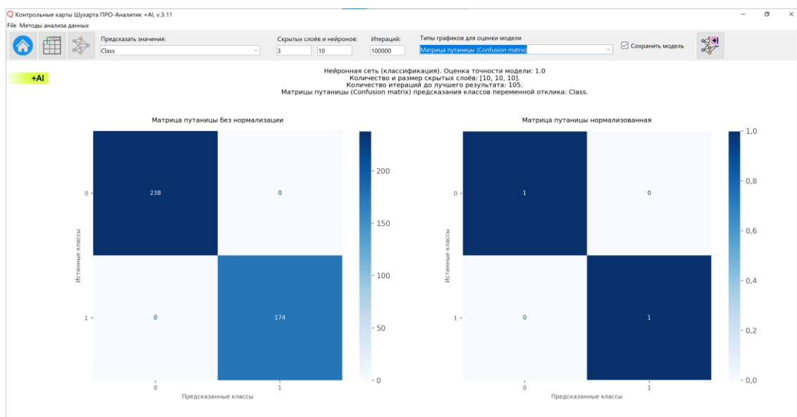
Рисунок 11. Окно функции управления обучением и оценкой математической модели нейронной сети (классификация) с графиками "матриц путаницы (confusion matrix)".
