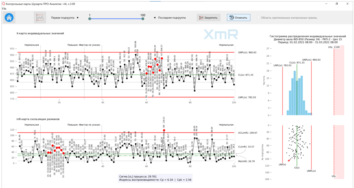
Рисунок 6. Контрольные границы для всего ряда данных - без закрепления. Использован тот же ряд данных, что и на рисунках 4 и 5.
