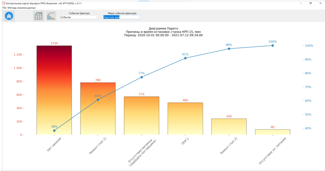
Рисунок 1. Диаграмма Парето (Pareto chart), выбрана мера события [Простой, мин]. ПО Контрольные карты Шухарта ПРО-Аналитик +AI
