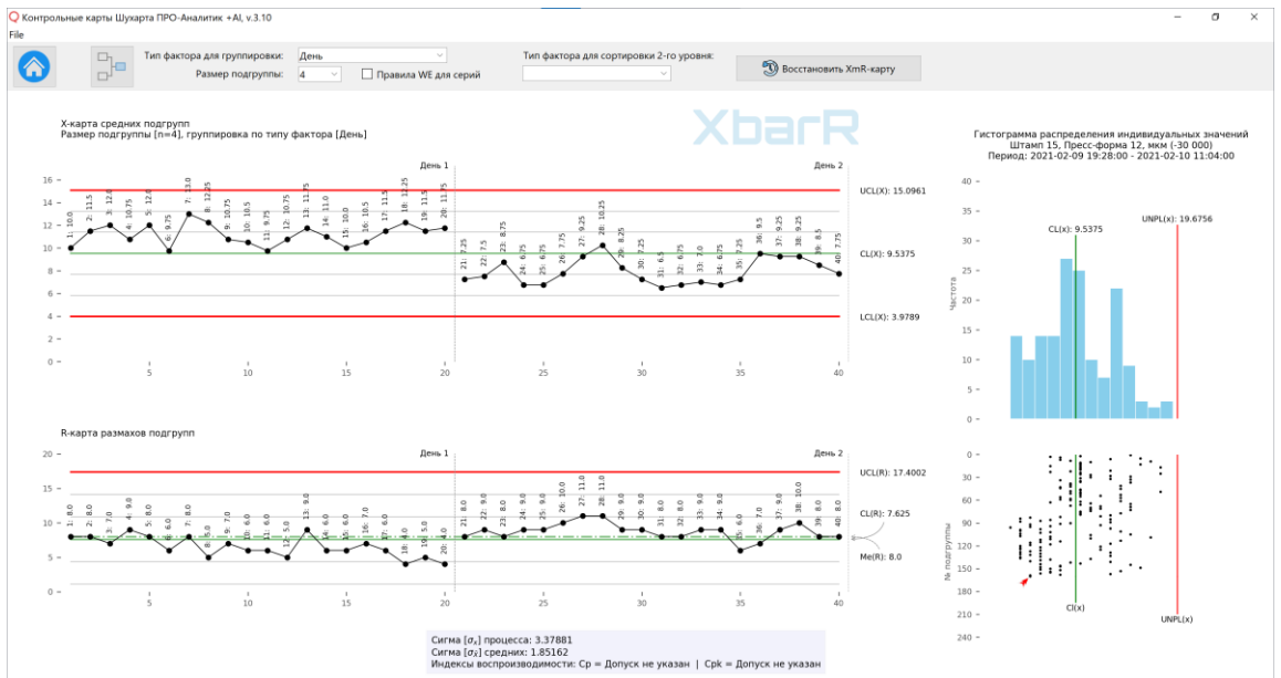
Рисунок 6. Контрольная XbarR-карта средних и групповых размахов для данных, организованных в рациональные подгруппы по типу факторов [День] с размером подгрупп [n=4], соответствующим количеству шаровых муфт, производимых за один цикл штампа. Включены Правила Western Electric 1 и 4 .
