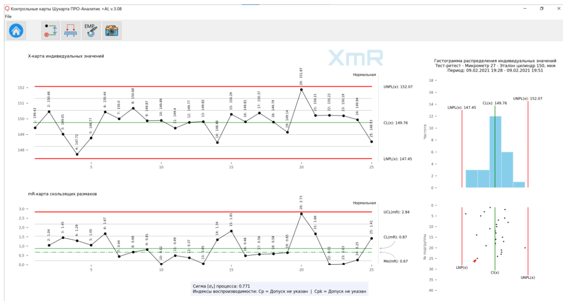
Рисунок 1. Двадцать пять значений повторных измерений (тест-ретест) эталона нанесены на контрольную XmR-карту индивидуальных значений и скользящих размахов. Измерительная система подтвердила статистически устойчивое состояние.
