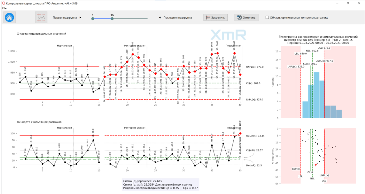
Рисунок 2. Расчёт и закрепление контрольных границ произведено до 15-й подгруппы (точки) XmR-карты с продлением контрольных границ на весь ряд данных пунктирной линией.
