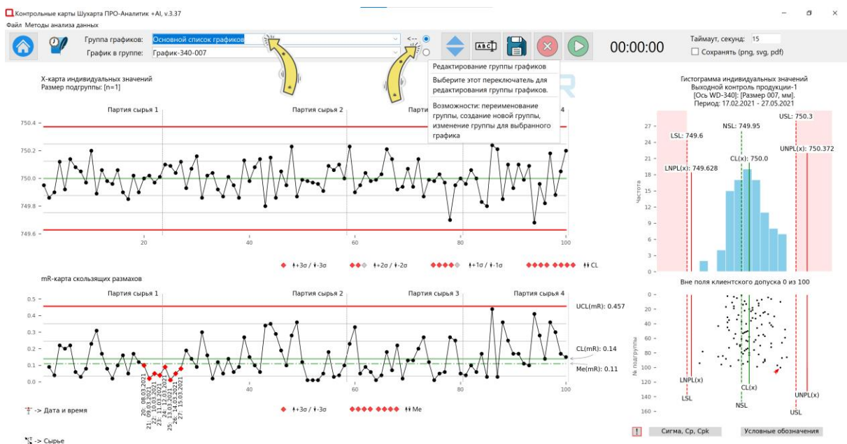
Рисунок 3. Выведена контекстная подсказка при наведении курсора мыши на активированную кнопку-переключатель редактирования групп графиков. Деактивированы кнопки сортировки списка графиков в группе, удаления графиков, запуска автоматического обновления графиков с установленным таймаутом.
